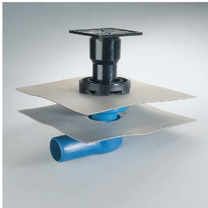
Receptor de balcon DN 50, cu ieșire orizontală, cu guler adevziv, prelungitor, parafrunzar mic și piesă de admisie circulabilă în trepte, pentru utilizarea în balcon.
